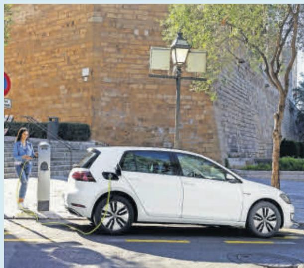
Le principali differenze fra la prima e la seconda generazione del modello e-Golf presentato su queste pagine, riguardano senza dubbio la parte elettrica. Oltre ad un motore più performante, la capacità della batteria è aumentata di quasi il 50%, passando da 24,2 a 35,8 chilowattora.
